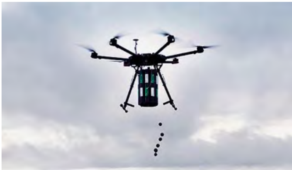
Slika 12. Na težko dostopnih območjih je bila preizkušena setev z droni in s semenskimi kroglicami.
